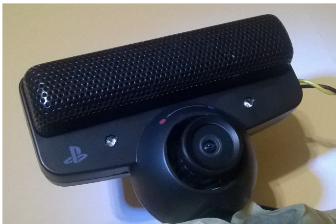
Rysunek 4.3: Kamera PlayStation Eye ze zmodyfikowanym obiektywem pozbawionym filtra podczerwieni
