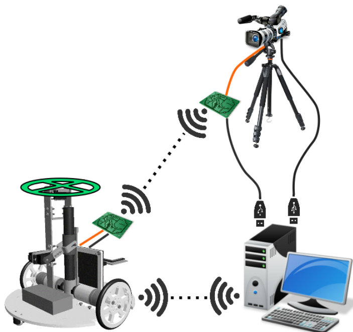
Rysunek 2.1: Schemat ideowy projektowanego systemu pozycjonowania robota mobilnego
