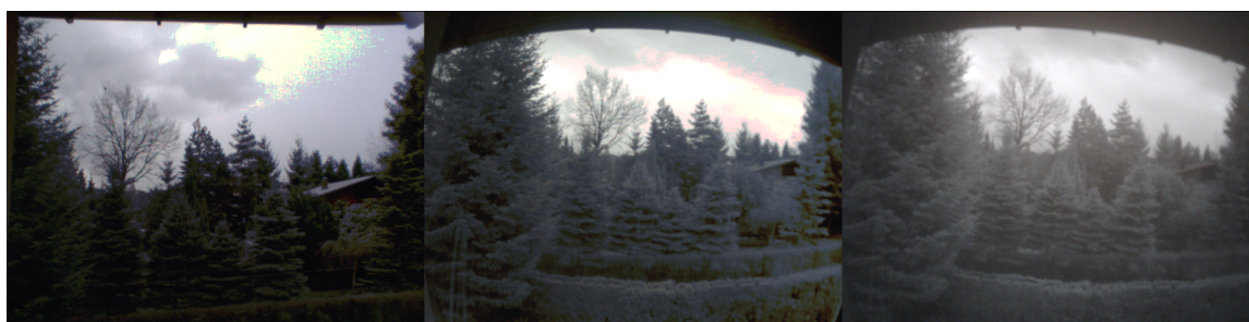
Rysunek 4.4: Porównanie kolorowych obrazów rejestrowanych za pomocą różnych obiektywów, od lewej standardowy obiektyw PlayStation Eye, zastępczy obiektyw pozbawiony filtra podczerwieni oraz ten sam po użyciu filtra dla światła widzialnego (rozdział 4.2.2)
