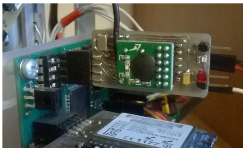
Rysunek A.4: Moduł odbiornika interfejsu radiowego przyłączony do kontrolera robota.
